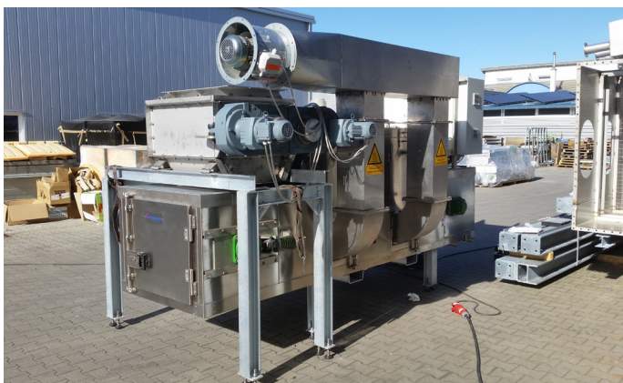
Tolva de alimentación y prensa de rodillos sobre el módulo de alimentación, conductos de extracción de aire y ventilador de extracción de aire a la derecha
