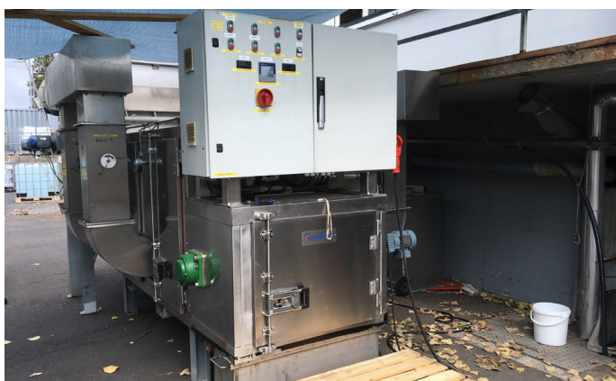
Module d'extraction avec bac d'épandage mobile et armoire de commande au-dessus
