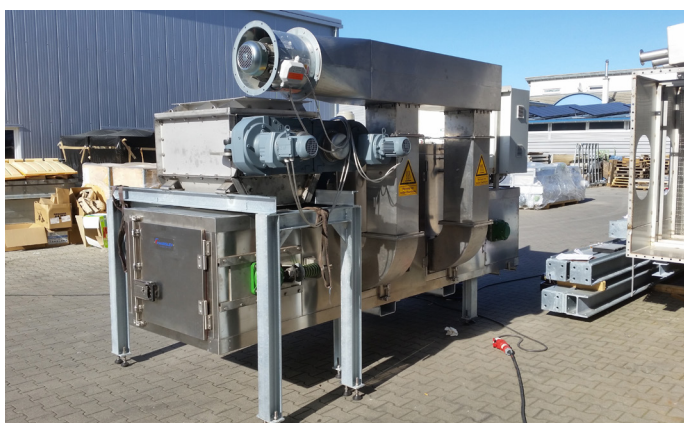
Trémie d'alimentation et presse à rouleaux au-dessus du module d'alimentation, à droite gaines d'évacuation d'air et ventilateur d'évacuation d'air
