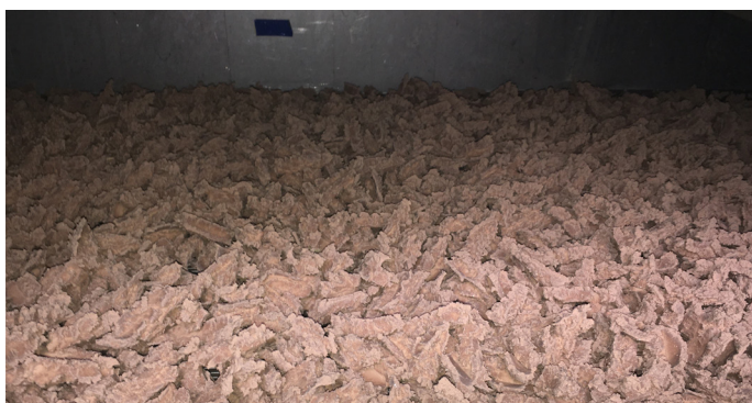
Vue dans le deuxième module de séchage avec matière sèche granulée
