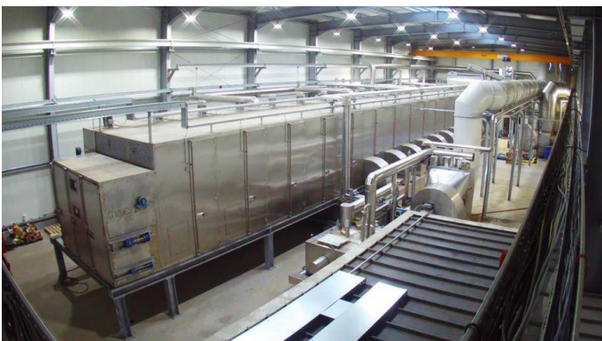
Sicht vom Ende des Bandrockners BD 3000/16 mit Umlenkammer und Abluftgebläse
