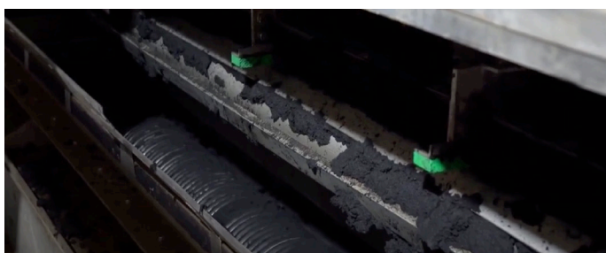
Aufgabereinheit mit Verteilerschlitten und Rollenpresse
