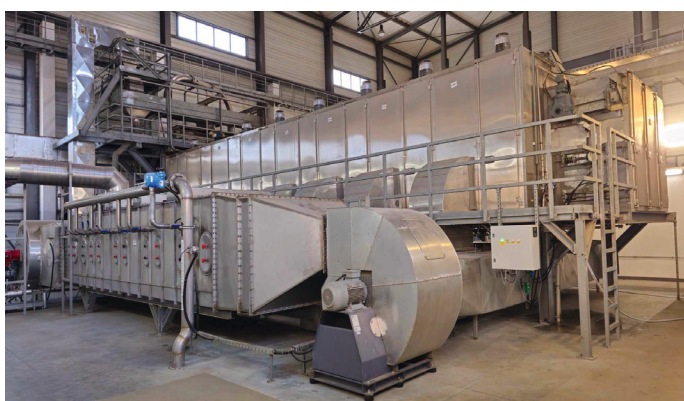
Bandrockner BD 3000/8 mit horizontalem direktem Kondensator und Abluftgebläse
