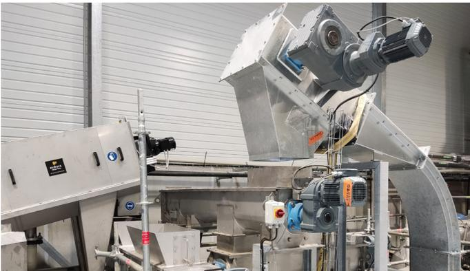
Rückmischung: Trogkettenförderer fördert Trockenschlamm in Dosierschnecke
