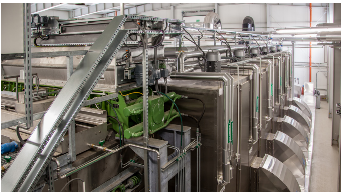
Erste Linie des Bandrockners BD 3000/6 mit Aufgabeeinheit
