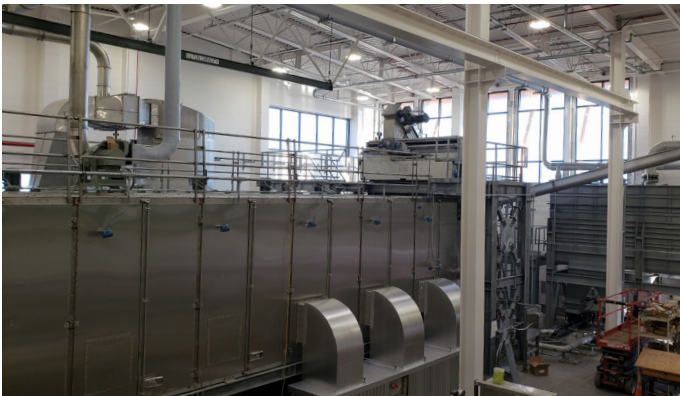
Bandrockner BD 3000/6 mit Abluftkanal, Aufgabeeinheit und Vorlagebehälter
