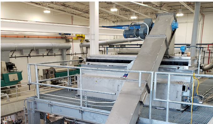
Kettenförderer (Nassprodukt) zur Aufgabereinheit (Verteiler-/Dosierer)
