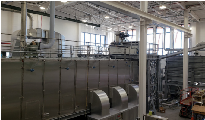
Bandrockner BD 3000/6 mit Abluftkanal, Aufgabereinheit und Vorlagebehälter
