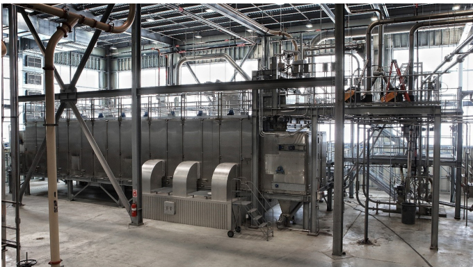
Bandtrockner (Linie 2) mit Rückmischung
