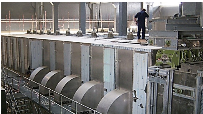
Eine Linie des Bandrockners BD 3000/12 mit Aufgabeeinheit
