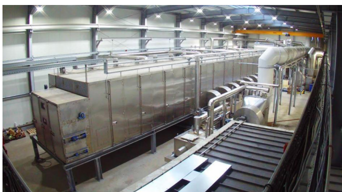
Vista desde el extremo del secador de bandas BD 3000/16 con cámara de desviación y extractor
