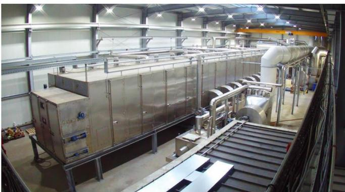
Vista desde el extremo del secador de bandas BD 3000/16 con cámara de desviación y extractor
