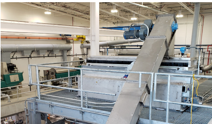
Transportador de cadena (producto húmedo) a la unidad de alimentación (distribuidor/dosificador)
