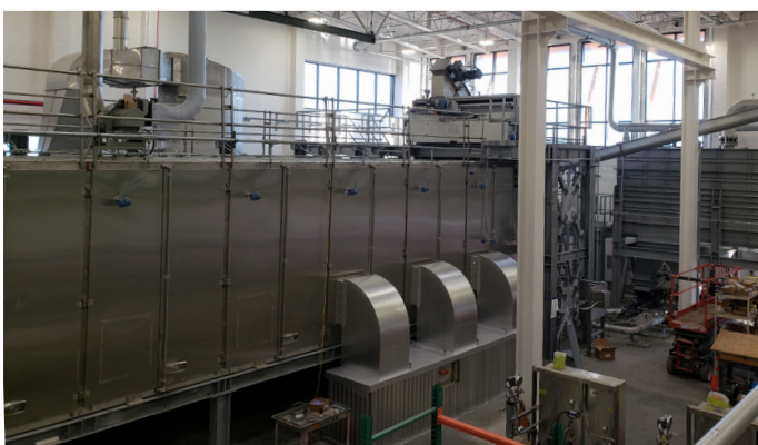
Secador de bandas BD 3000/6 con conducto de aire de escape, unidad de alimentación y depósito receptor
