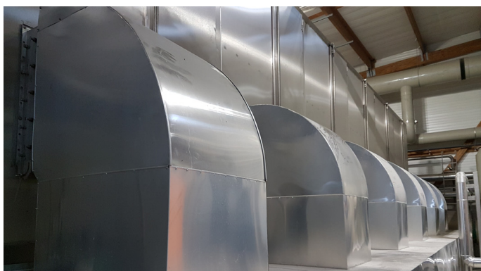
Secador de banda BD 3000/7 con conductos de aire de escape
