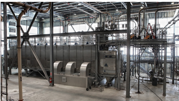
Secador de cinta (línea 2) con mezcla posterior
