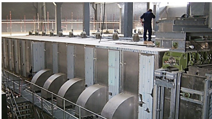
Una línea del secador de banda BD 3000/12 con unidad de alimentación
