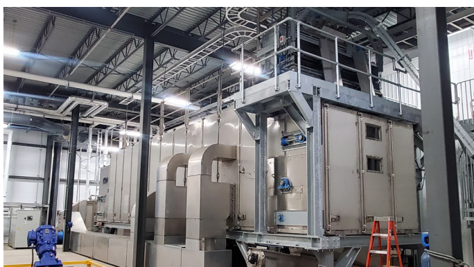
Secador de banda BD 3000/6 con unidad de alimentación, tornillo de descarga y conducto de aire de alimentación
