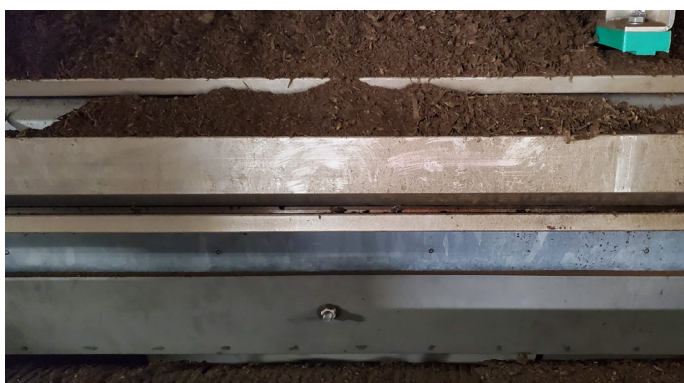
Material presecado encima de la prensa de rodillos para su alimentación a la banda superior del secador
