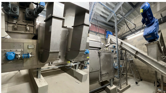
Izquierda: Secador piloto con unidad de alimentación y conductos de escape Derecha: Alimentación del producto mediante sinfín
