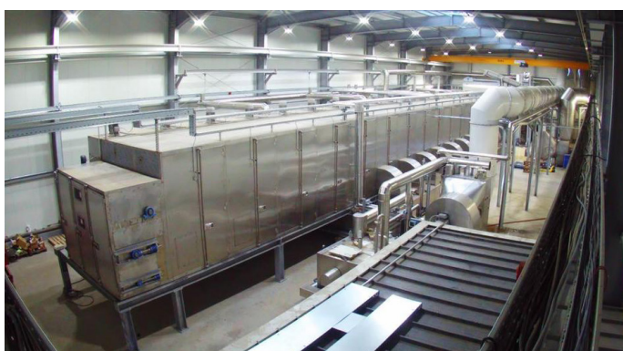
Vue de l'extrémité du sécheur à bande BD 3000/16 avec Chambre de déviation et ventilateur d'évacuation d'air
