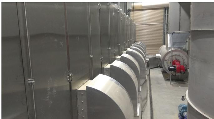
Brûleur (rouge) avec chambre de combustion suivie d'un ventilateur d'alimentation en air pour le transport du gaz chaud dans le sécheur à bande
