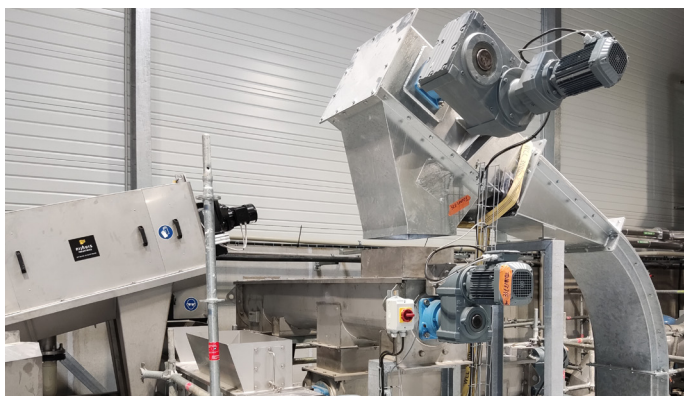
Remélange : le transporteur à chaîne achemine les boues sèches vers la vis de dosage
