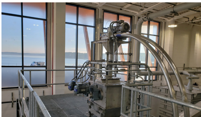
Convoyeur à chaîne tubulaire (produit sec) vers le broyeur de produits
