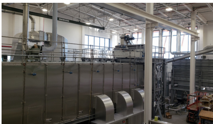
Sécheur à bande BD 3000/6 avec canal d'évacuation, unité d'alimentation et réservoir collecteur
