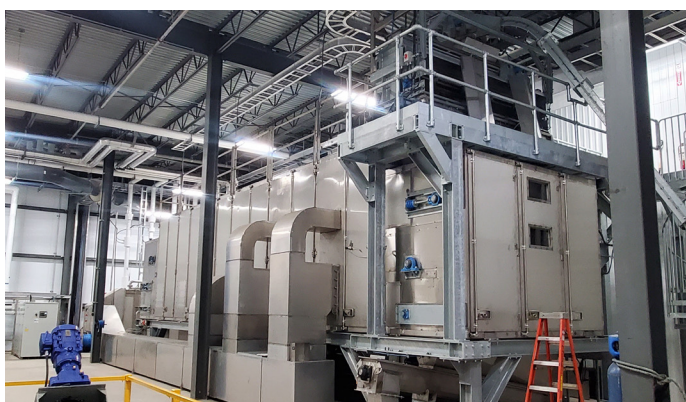
Sécheur à bande BD 3000/6 avec unité d'alimentation, vis d'extraction et canal d'amenée d'air
